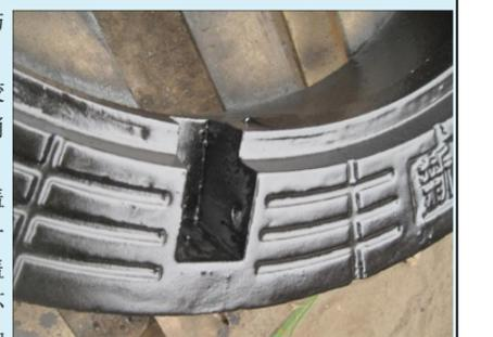
③防盗:在井盖外圈上,凸出一方形槽,其井盖内壁端的开口环通过井座固定轴与井盖连接,另一端内壁设销体固定,而起到防盗作用。
